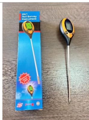
pH метри за измерване киселинността на компоста по време на ферментация;
