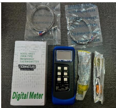
Контактен термометър (2 бр.) - оборудван с дълга сонда с която се измерва температурата в центъра на компостния ред;
