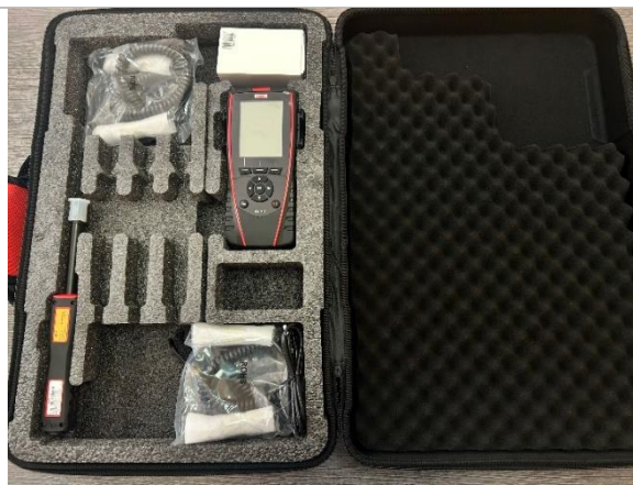
Сонда за измерване на CO2 (1 бр.) - използва се за измерване на процентното съдържание на CO2 в компостните редове
