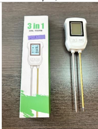
Влагомер с удължен сензор (2 бр.) - за измерване влажността на компоста в различни части на компостния ред
